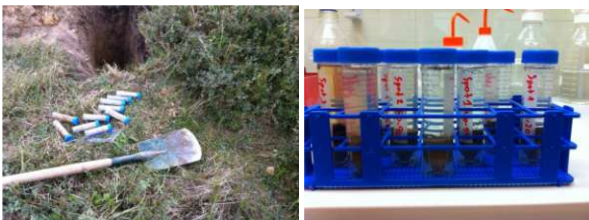
Figuur 2.5. Het steken van bodemkernen via een kuil en de extractie van bodemvocht door na droogrestbepaling 20 gram grond te mengen met 40 cc gedemineraliseerd water.
