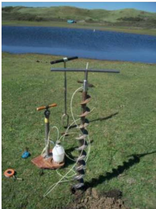
Figuur 2.6. Bemonstering van ondiep grondwater met de spiraalboor ontworpen door VU.
