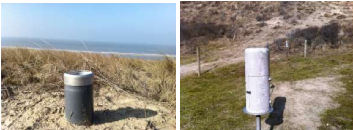
Figuur 2.4. De gebruikte bulk regenvangers: kleine type VU (links) en grote type KNMI (rechts).
