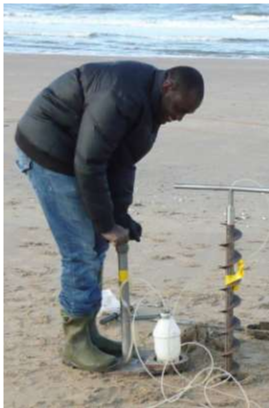
Figuur 2.6. Bemonstering van ondiep grondwater met de spiraalboor ontworpen door VU.
